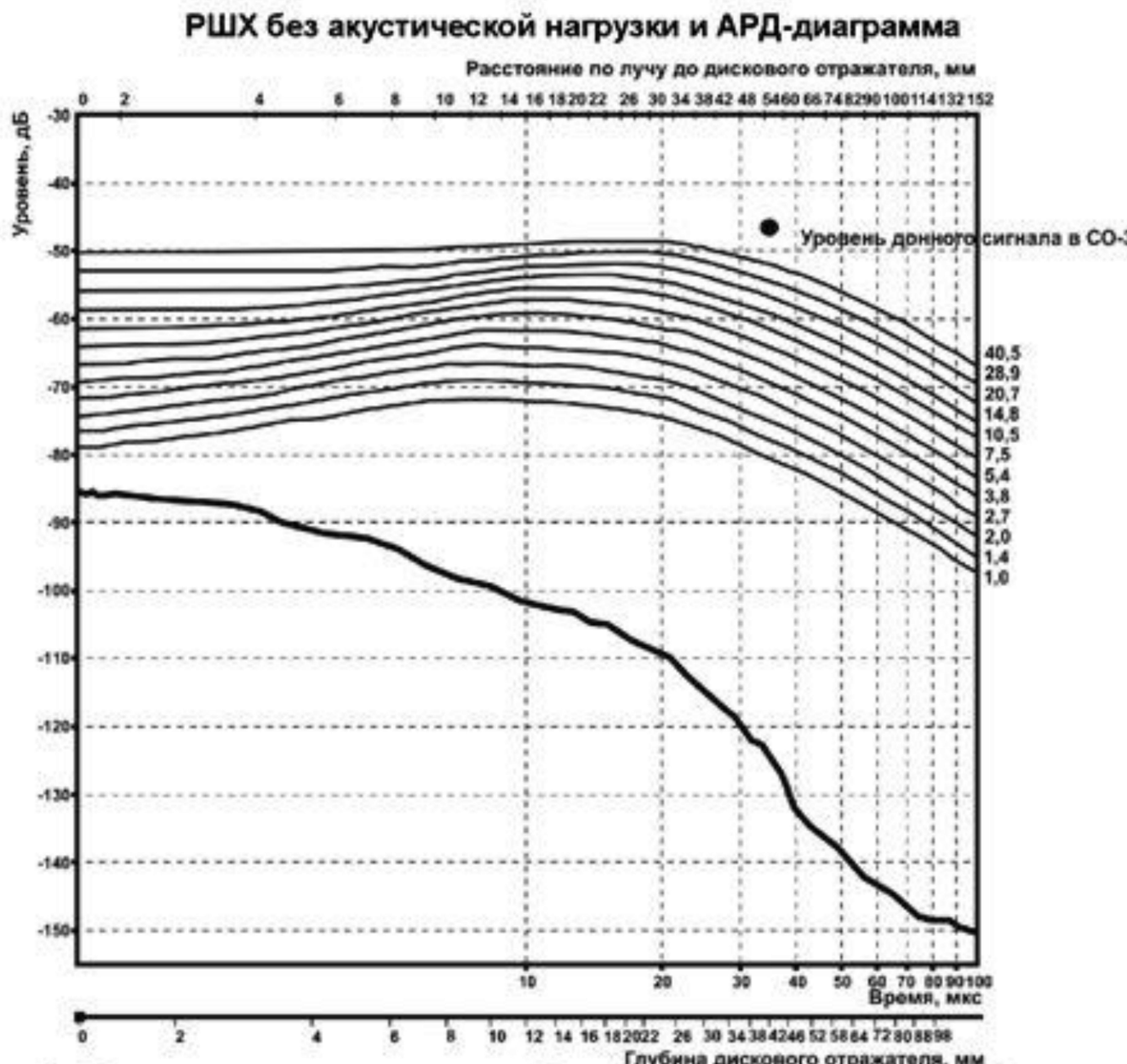
За уровень 0 дБ принята амплитуда импульса возбуждения преобразователя (20 В). Разметка времени по горизонтальной оси соответствует распространению сигнала только в материале объекта контроля. Справа от кривых АРД указана площадь соответствующего дискового отражателя в квадратных миллиметрах.
