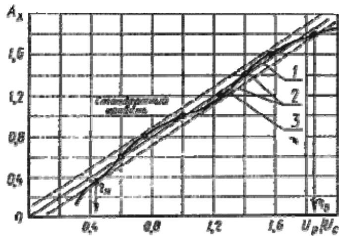
1 - линия идеальной линейности, проведенная через начало координат и точку, полученную на стандартном уровне; 2 - верхняя и нижняя границы нелинейности, проведенные параллельно линии 1; 3 - амплитудная характеристика приемного тракта;  $\eta_p, \eta_c$  - верхняя и нижняя границы динамического диапазона в дБ
