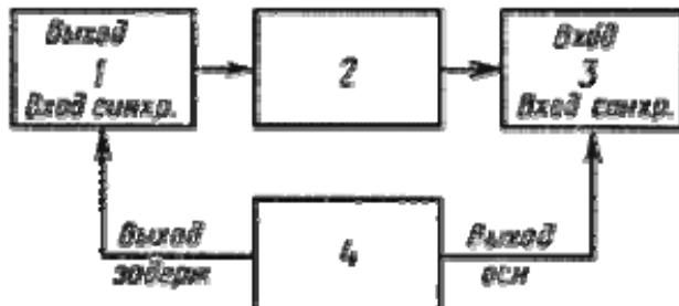
1 - электронный блок дефектоскопа; 2 - номинальный эквивалент нагрузки генератора импульсов возбуждения;
